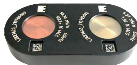
※標準校正用試験片 NPL(英国国立物理学研究所)によるAC電流測定
