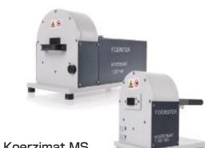
材料の磁気飽和分極や双極子モーメントを、部品形状に関係なく高速で測定する優れた装置です。粉末冶金では、重量および体積に固有の飽和分極は、材料の製造工程中に重要な指標となります。材料の重量または密度が分かっている場合、KOERZIMAT®ソフトウェアはこれら2つの材料パラメータを自動的に計算します。測定値をコバルトやニッケルの材料定数と比較した後、KOERZIMAT MSソフトウェアは磁性結合材の含有量を評価します。
