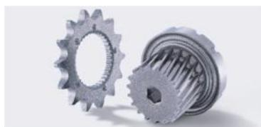
コスト面の理由から、複雑な形状の部品は焼結により製造されることが多くあります。これにはハウジングやファスナーなど軟磁性の部品、駆動装置やモーターなど機械的ストレスを受ける部品が含まれます。Fe(鉄)粉末の原材料品質および焼結前後の粒のサイズと均一な分布は、製造される部品の強度や耐摩耗性などの機械的特性を決定する要因となります。これらのパラメータは保磁力の測定値と相関があります。KOERZIMAT®は、粉体品質の評価から焼結工程の評価まで、製造工程全体の監視に使用できます。
