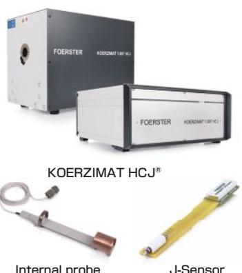
高感度fluxgateセンサーによりサンプルから十分な距離を取り全体を測定することでサンプル形状による影響を最小化し、2019年1月に37年ぶり改定された『IEC60404-7開磁路中の磁気材料の飽和保磁力(160kA/m以下)』でVSM方式(振動試料型磁力計)やHallセンサー方式が排除される中、「楕円体以外の形状についても積分測定を行うことができる方式」として規準に採用されました。欧米の主要超硬合金・粉体冶金・SMC部品製造メーカー等で採用されています。
