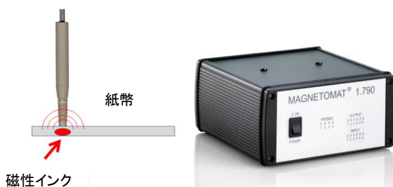
図1 左：PD-100-20 プローブを使用した紙幣の磁性ホットスポットスキャン、右：MAGNETOMAT 1.790（自動化アプリケーション用に設計）
