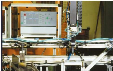
▲ 連続する複数の検査ステーションにおいて、各ピボット部材を渦流で検査し、表面さすと熱処理状態を検査します。
