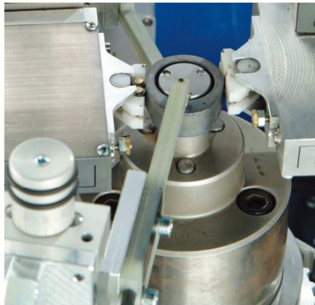
▲ 個々のカムの接触箇所を2個の探傷プローブで検査。また、各端面を各1個の探傷プローブで検査し、クラック検出を行います。
