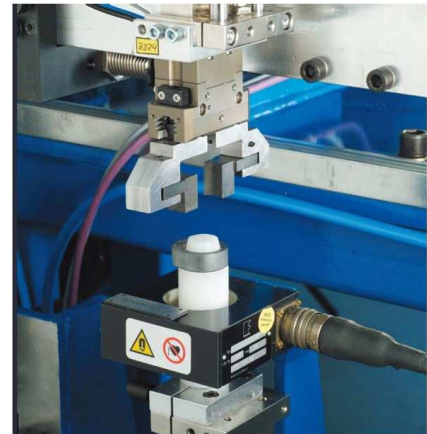
▲ 別個のステーションで貫通型マグナテスト®検査コイルを使ってマイクロ組織検査を行います。
