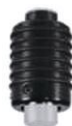
(左写真) フェルスター製SIGMATEST®の14mmプローブとハンドグリップ
