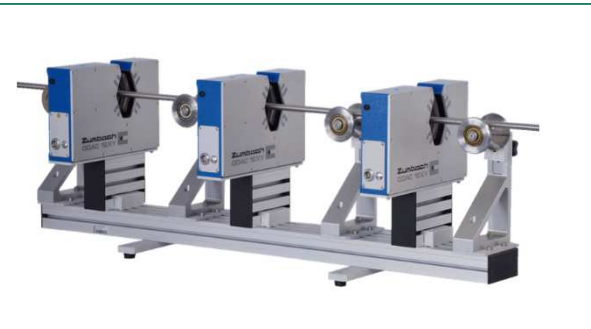
棒・管のオンライン曲り測定
